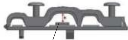
Khi cáp chưa được cố định đủ chắc, hãy sử dụng khóa để đỡ cáp sao cho có thể kẹp chặt cáp.
