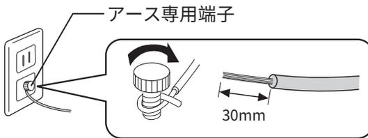
アース線先端の剥きしろを30mmに切断して、アース端子に確実に固定してください。
