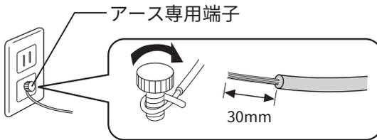
アース線先端の剥きしろを約30mmに切断して、アース端子に確実に固定してください。
