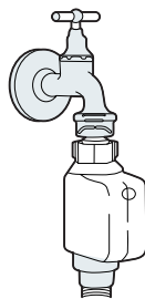
tubo di alimentazione di sicurezza
