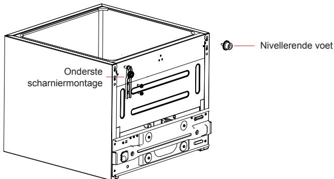
6) Plaats de deur verticaal op het onderste scharnier en bevestig de gasdichtheid van de deurpakking, installeer vervolgens het bovenste scharnier door middel van schroeven en het scharnierdeksel, en dek ten slotte de gatenkappen aan de rechterbovenzijde af.
