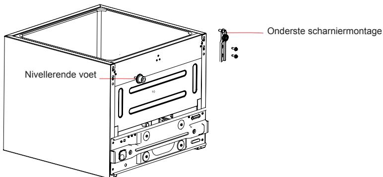
5) Installeer het onderste scharnier en de nivelleringsvoet aan de linker onderzijde van de kast, respectievelijk de rechter onderzijde;
