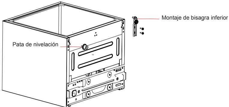
5) Instale la bisagra inferior y la pata de nivelación del lado izquierdo inferior del gabinete y del lado derecho inferior respectivamente;
