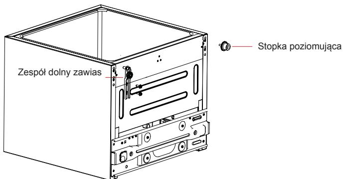
6) Ustaw drzwi pionowo na zawiasie dolnym i sprawdź szczelność uszczelki drzwiowej, następnie zamontuj zawias górnego za pomocą śrub mocujących i osłonę zawiasu, a na końcu zakryj zaślepki otworów u góry po prawej stronie.
