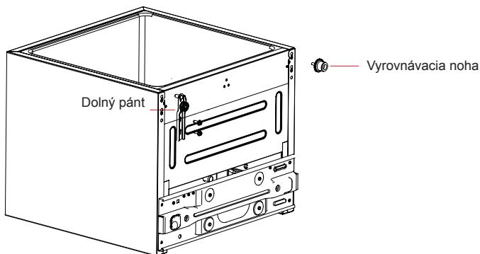
6) Dvere nasaďte vertikálne na dolný pánt a overte plynotesnosť tesnenia dverí. Potom namontujte horný pánt pomocou skrutiek a kryt pántu, nakoniec kryty otvorov na pravej hornej strane.
