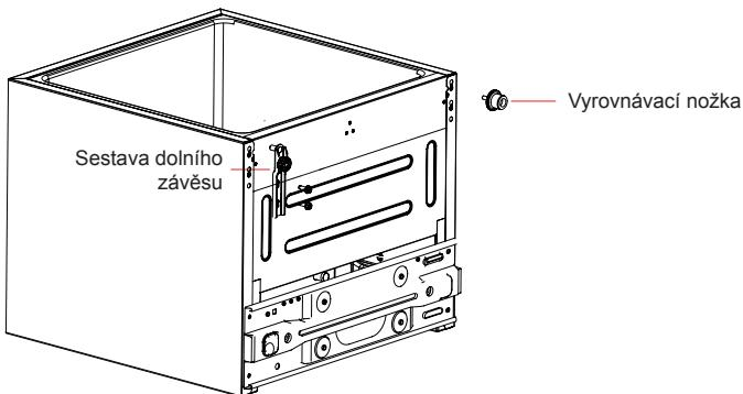
6) Dvířka nasadte svisle na spodní závěs a ověřte plynотěsnost těsnění dveří, poté namontujte horní závěs pomocí šroubů a krytu závěsu, nakonec zakryjte uzávěry otvorů na pravé horní straně.
