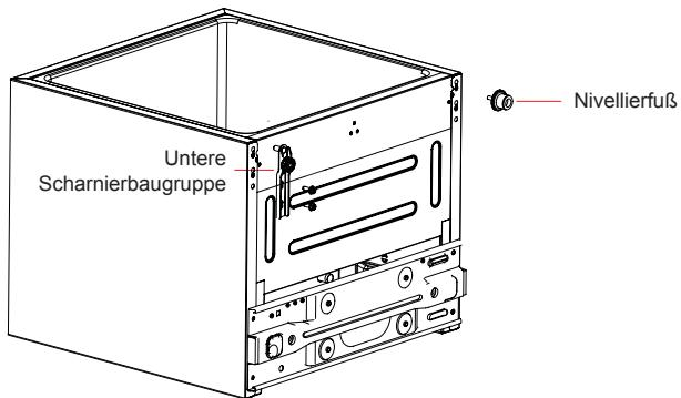
6) Setzen Sie die Tür senkrecht auf das untere Scharnier und prüfen Sie die Gasdichtigkeit der Türdichtung, dann montieren Sie das obere Scharnier mit den Schrauben und der Scharnierabdeckung und decken schließlich die Lochkappen auf der rechten oberen Seite ab.
