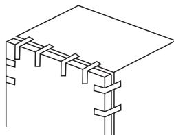
2) Demontujte kryty otvorov, kryt horného pántu, upevňovacie skrutky horného pántu a demontujte horný pánt. Počas celého procesu ponechajte dvere vertikálne, aby nedošlo k pádu;
