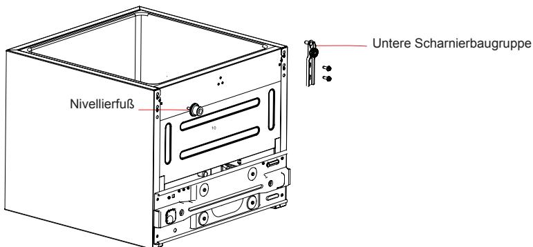
5) Montieren Sie das untere Scharnier und den Nivellierfuß an der unteren linken Seite des Schranks bzw. an der unteren rechten Seite;
