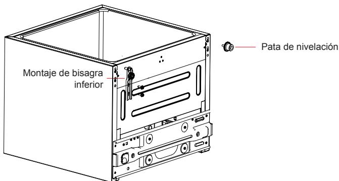
6) Coloque verticalmente la puerta sobre la bisagra inferior y valide la estanquidad de la junta de puerta, luego instale la bisagra superior ajustando los tornillos y la cubierta de bisagra, finalmente cubra las tapas de orificios del lado derecho superior.
