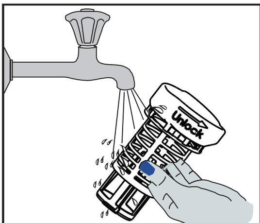
Parce que les agents chimiques d'une eau dure peuvent obstruer les jets des bras gicleurs et les systèmes de roulement, il est essentiel de nettoyer régulièrement les bras gicleurs. Les laver dans une eau tiède savonneuse et utiliser une brosse douce pour frotter les buses. Replacer les bras gicleurs après les avoir rincés à fond.
